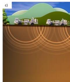
Les camions vibrent quelques dizaines de secondes tous les 20m avant de poursuivre leur route. Une onde acoustique est émise et se propage dans le sous-sol.
