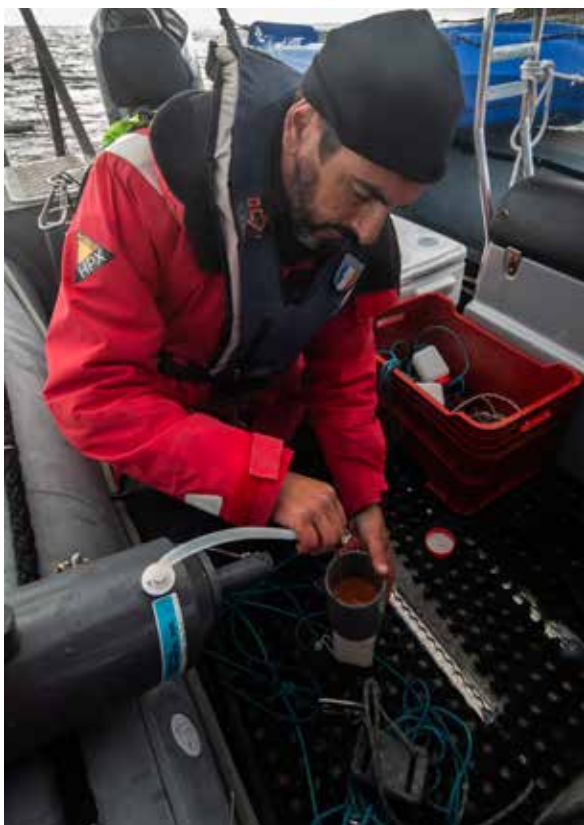
Prélèvement d'eau réalisé par un agent grâce à une bouteille Niskin. © Laëtitia Beauverger / OFB
