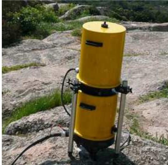
*Figure 69 : Gravimètre (instrument de mesure)*
