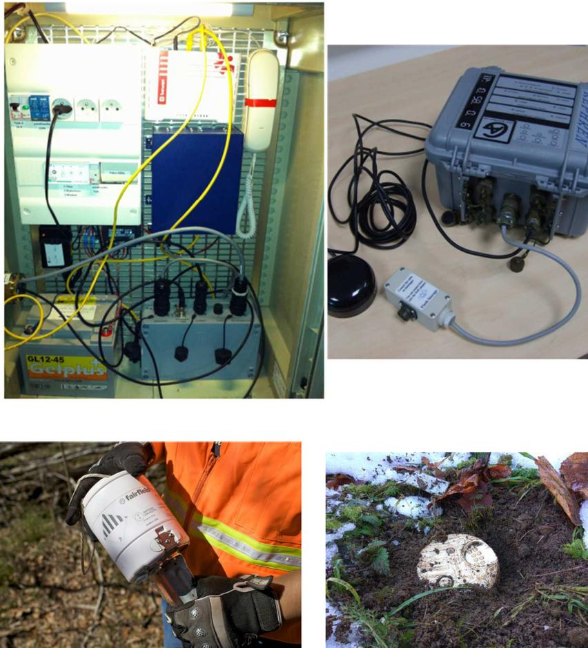
Figure 70 : Ensemble d'instruments de mesures du bruit sismique et des séismes (station large bande fixe, station large bande mobile, géophone autonome pour tomographie sismique)
