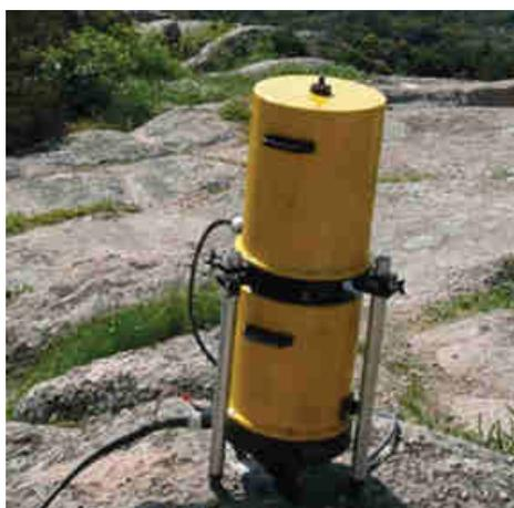
Figure 63 : Gravimètre (instrument de mesure)
