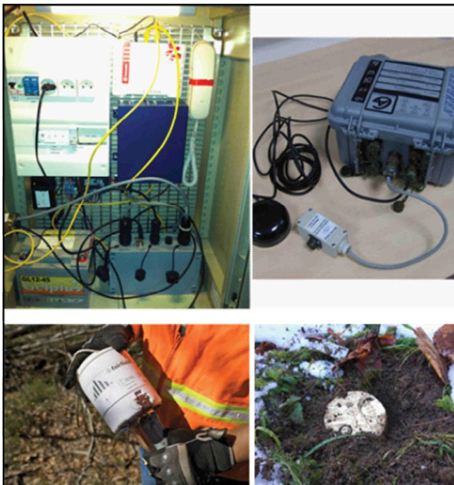
**Figure 64 : Ensemble d'instruments de mesures du bruit sismique et des séismes (station fixe, station mobile, géophone)**
