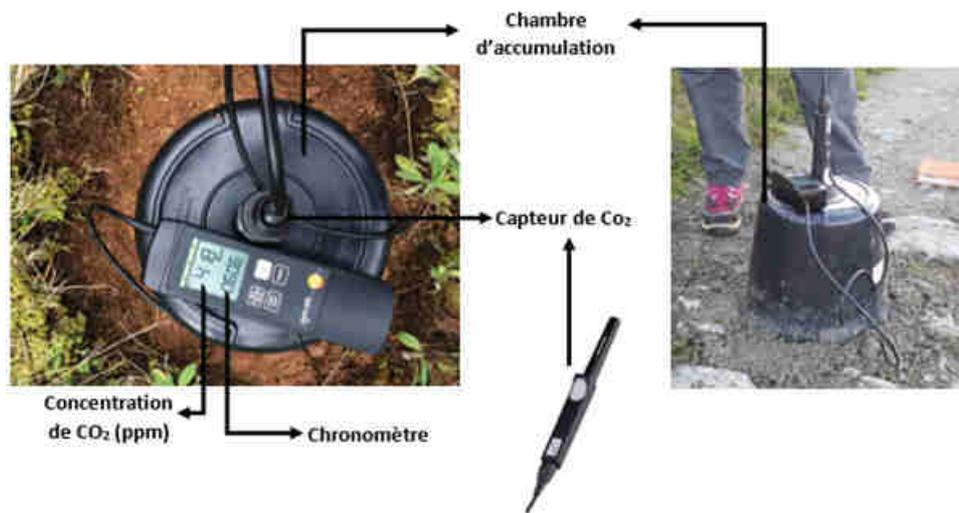
Figure 65 : Instrument de mesures du CO<sub>2</sub> s'échappant naturellement du sous-sol.
