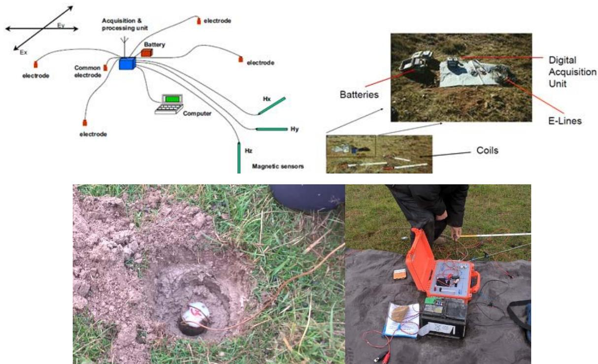
Figure 57 : Dispositif en surface des instruments de MT
