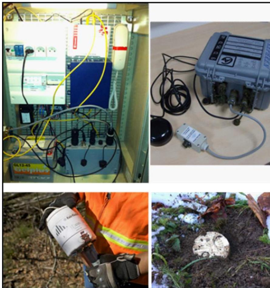
Figure 59 : Ensemble d'instruments de mesures du bruit sismique et des séismes (station fixe, station mobile, géophone)
