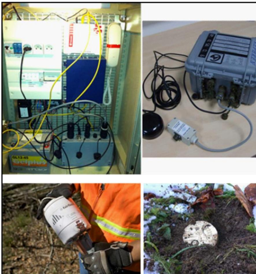
Figure 70 : Ensemble d'instruments de mesures du bruit sismique et des séismes (station fixe, station mobile, géophone)
