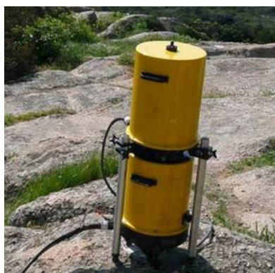
Figure 69 : Gravimètre (instrument de mesure)
