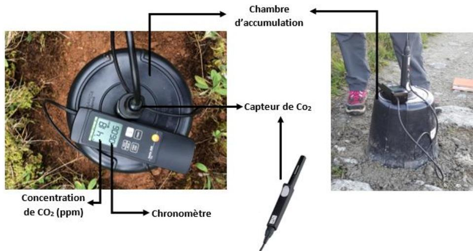
Figure 71 : Instrument de mesures du CO<sub>2</sub> s'échappant naturellement du sous-sol.
