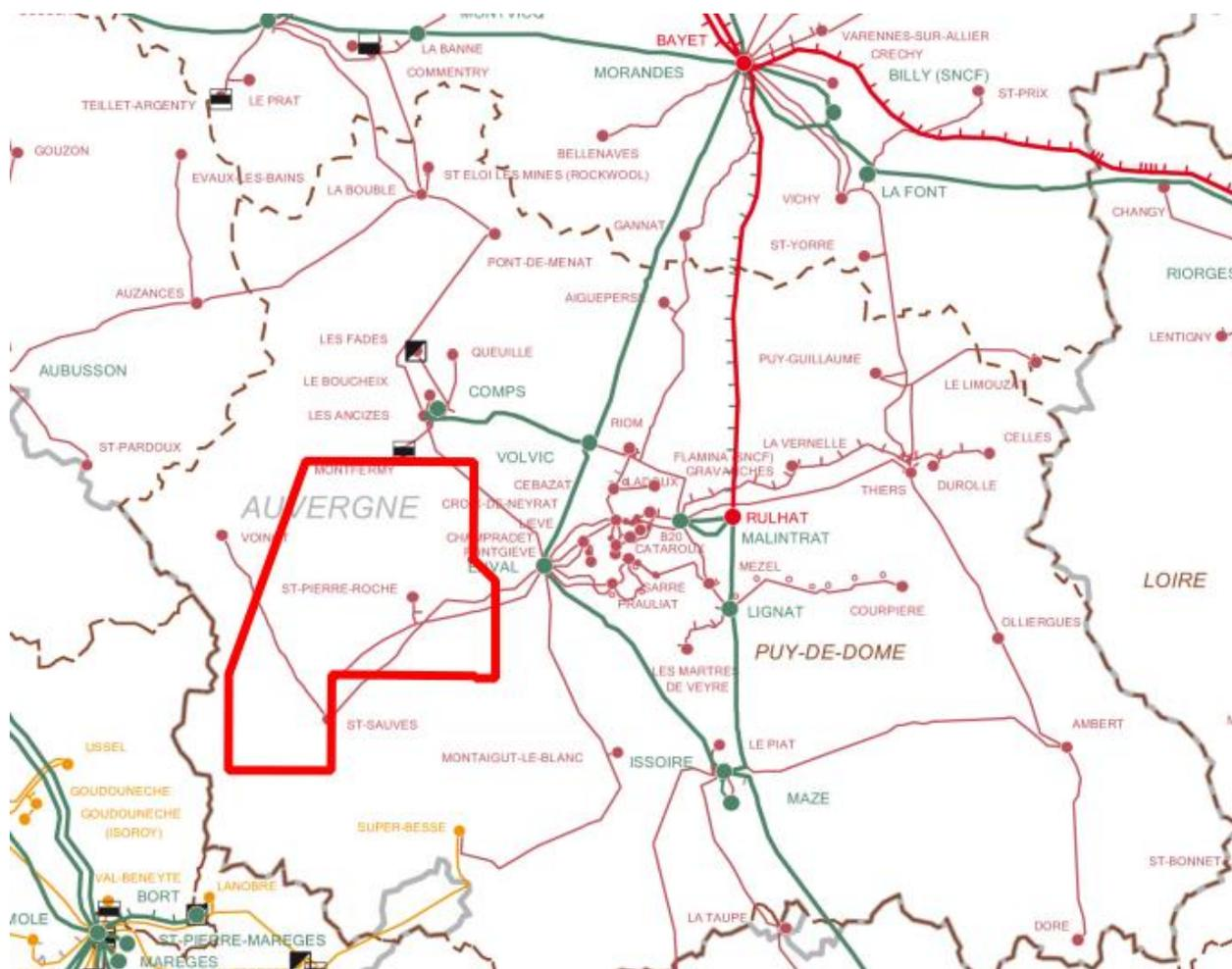
Figure 9 : Permis sollicité et réseau de transport dans le Puy-de-Dôme (RTE) / Lignes supérieures à 63 kV
