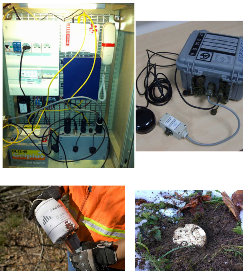
Figure 66 : Ensemble d'instruments de mesures du bruit sismique et des séismes (station large bande fixe, station large bande mobile, géophone autonome pour tomographie sismique)
