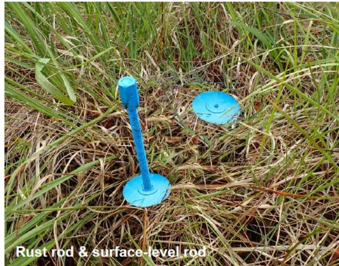
Photo 1 - A gauche un pôle de subsidence installé avec le repère situé à la surface du sol (Lindsay, 2019)
