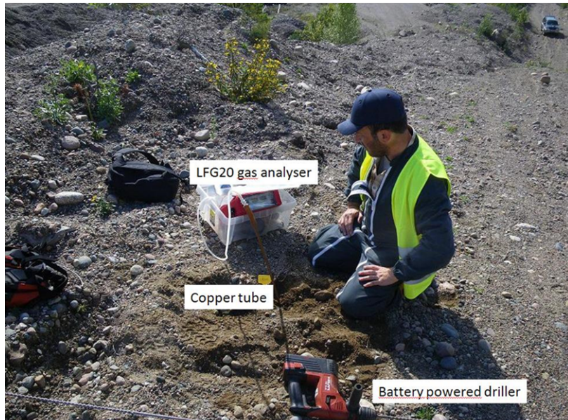
Figure 9 : Procédure d'échantillonnage des gaz dans les sols montrant la perforatrice de petit diamètre, le tube de cuivre installé à 1 m de profondeur et l'analyseur de gaz (BRGM)
