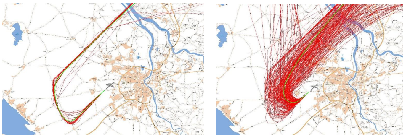
Figure 15 : Distinction des arrivées 05 en deux flux (VOR-DME à gauche et approches à vue à droite)
