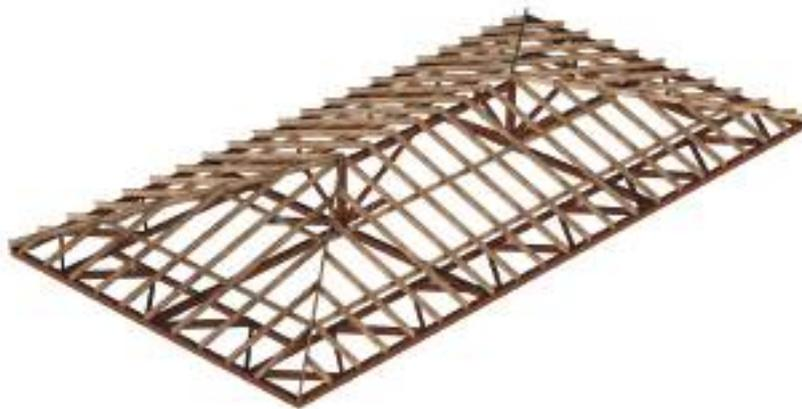
Figure 21 : Exemple de contreventement d'une charpente à 4 versants par poutres au vent horizontales dans le plan des entrails
