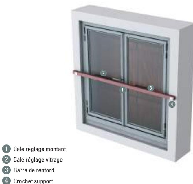
Figure 129 : Principe de menuiserie renforcée
