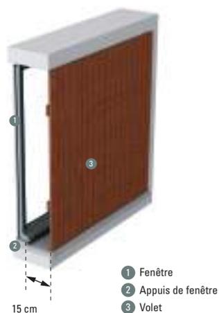
Figure 124 : Distance entre la fenêtre et la protection faiblement poreuse (cas 2a)
