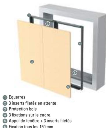
Figure 127 : Exemple d'un principe de protection provisoire
