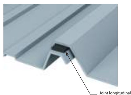
Figure 98 : Joint longitudinal en polyéthylène adhésivé
