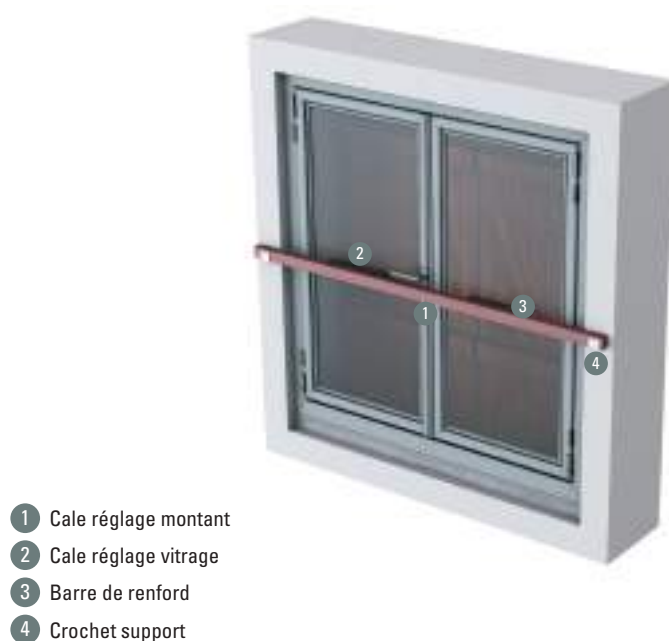
Figure 128 : Principe de menuiserie renforcée
