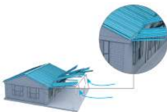
Figure 102 : Cas d'un auvent désolidarisé
