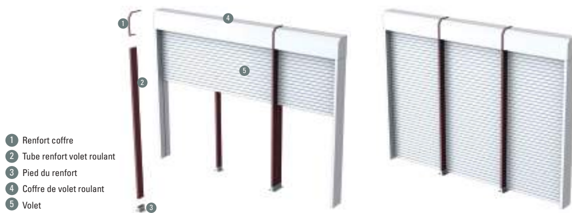
Figure 134 : Exemple de renforts sur volet roulant
