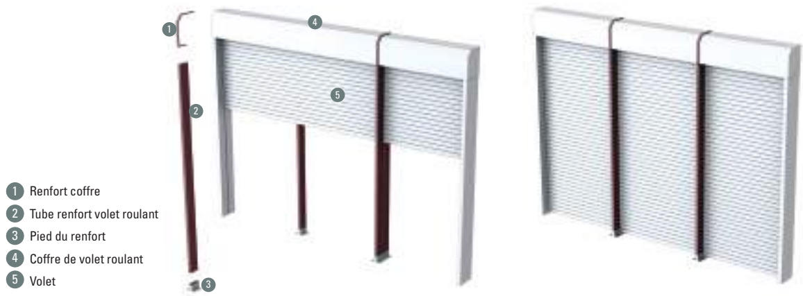
Figure 141 : Exemple de renforts sur volet roulant
