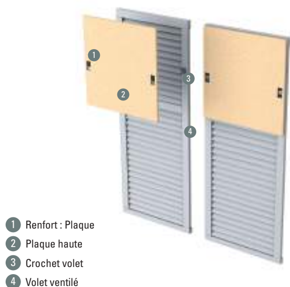
Figure 132 : Exemple de renfort aux chocs sur un volet ventilé
