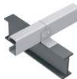
Figure 52 : Exemple de fixation des pannes aux fermes
