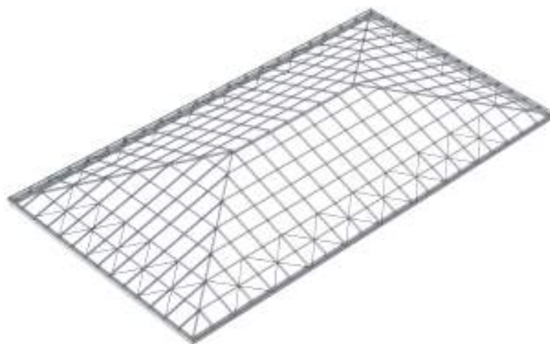
Figure 44 : Exemple d'une charpente à 4 versants
