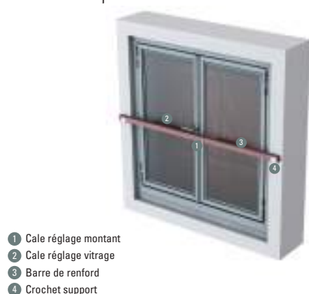
Figure 121 : Renfort de menuiserie
