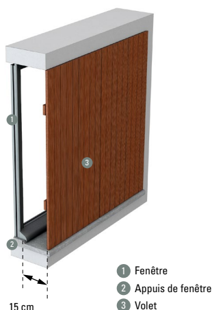
Figure 129 : Distance entre la fenêtre et la protection faiblement poreuse (cas 2a)
