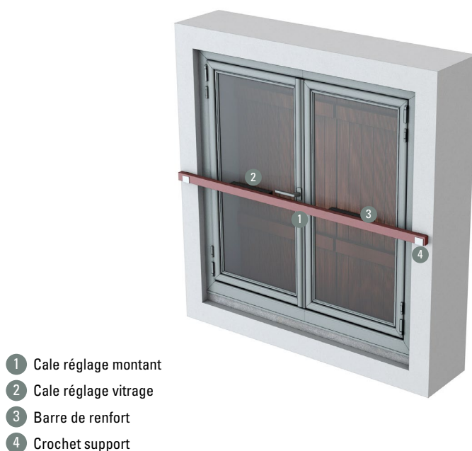
Figure 134 : Principe de fenêtre renforcée
