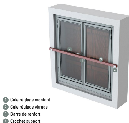
Figure 127 : Renfort de fenêtre
