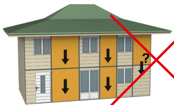
Mur de contreventement d'étage non fondé : non admis
