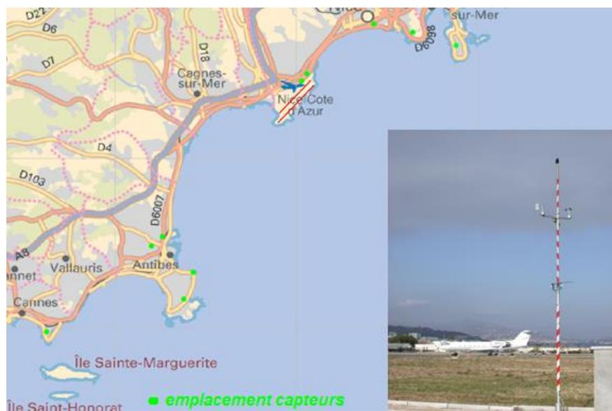
Figure 19 – Localisation des capteurs de bruit fixes
