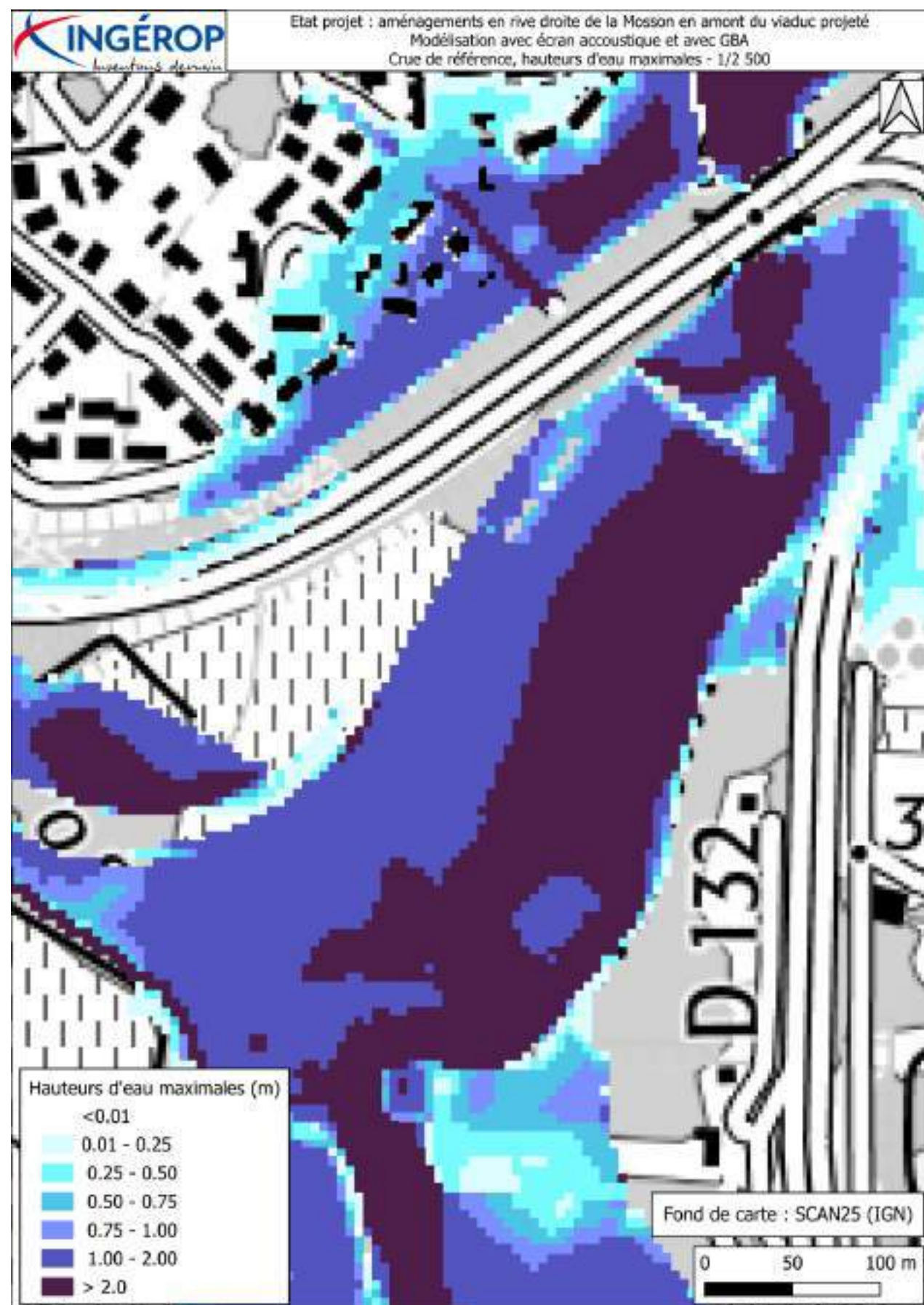
Figure 99 : Hauteurs d'eau maximales du scénario projeté, crue de référence - Zoom sur l'emprise projet
