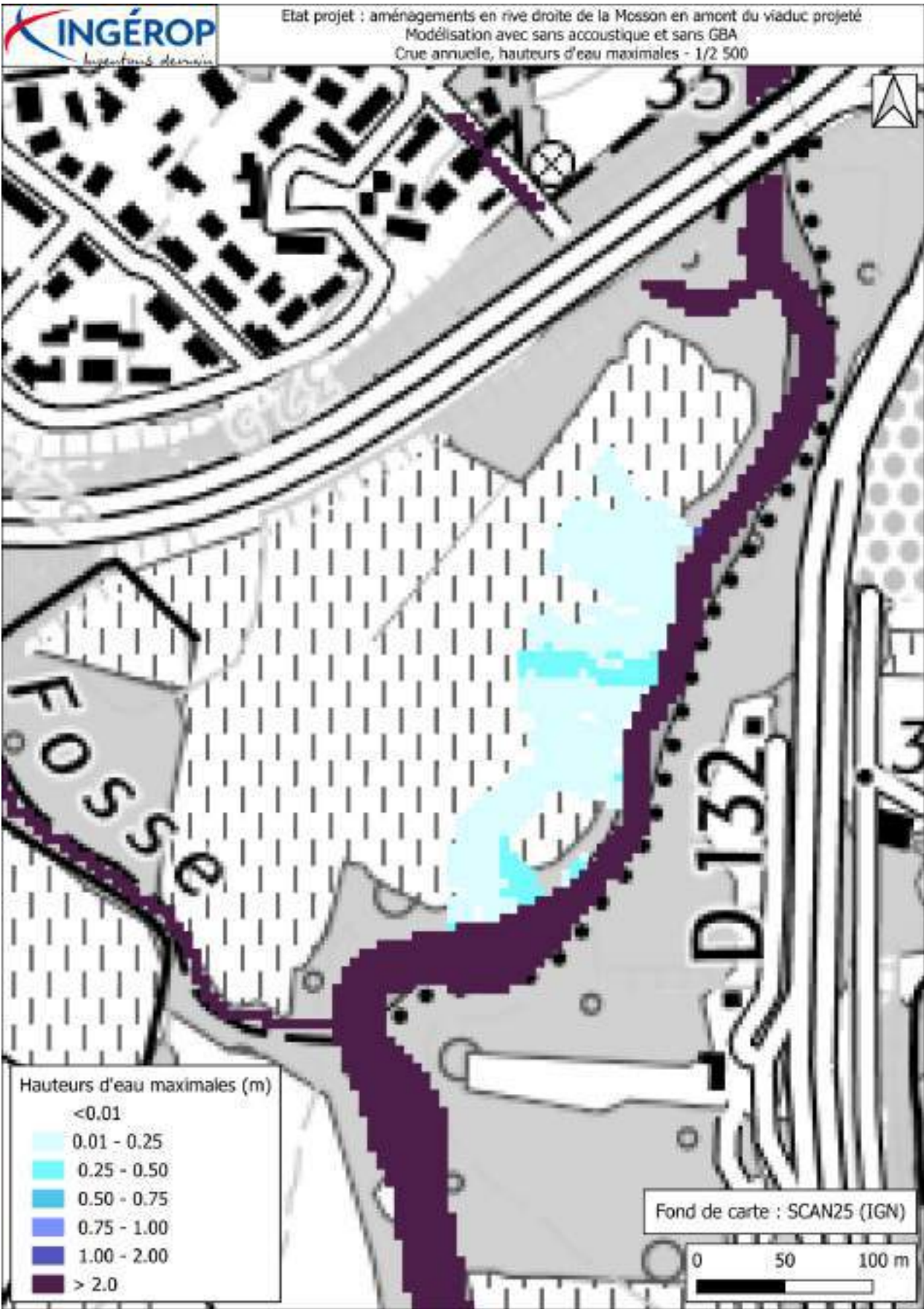
Figure 91 : Hauteurs d'eau maximales du scénario projeté, crue annuelle - Zoom sur l'emprise projet
