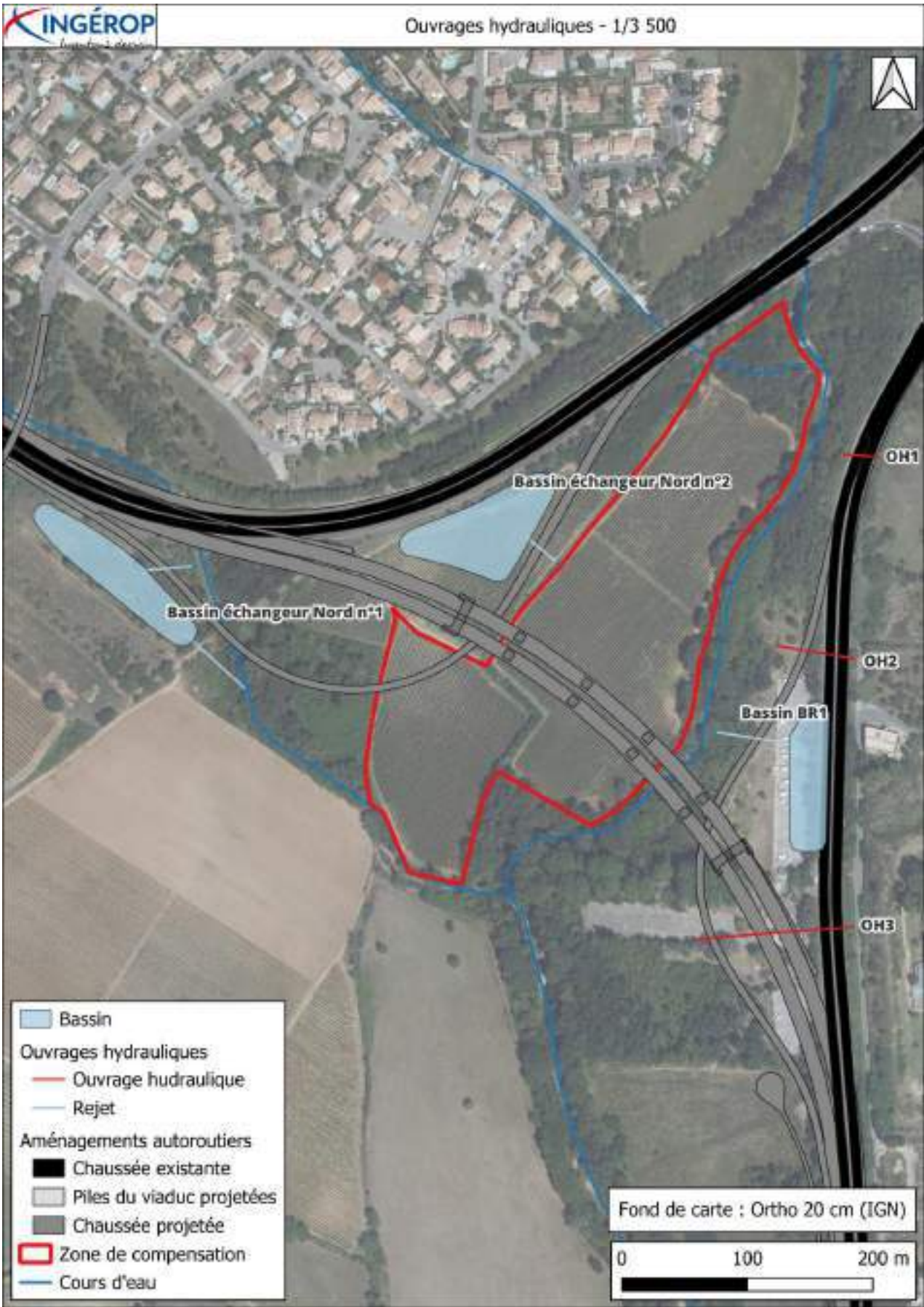
Figure 79 : Ouvrages hydrauliques – Zoom sur l'emprise projet
