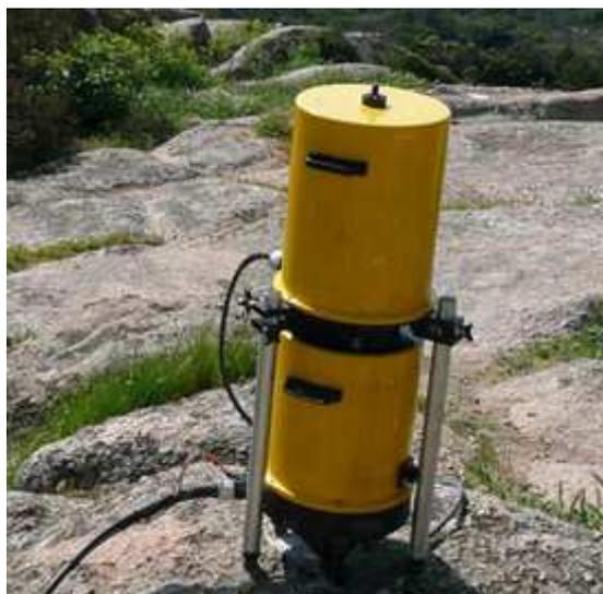
Figure 66 : Gravimètre (instrument de mesure)
