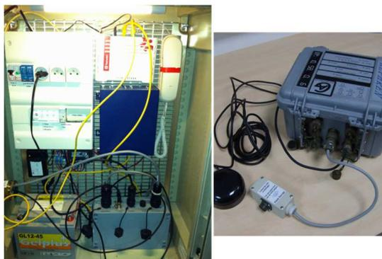
Figure 67 : Ensemble d'instruments de mesures du bruit sismique et des séismes (station fixe et station mobile)
