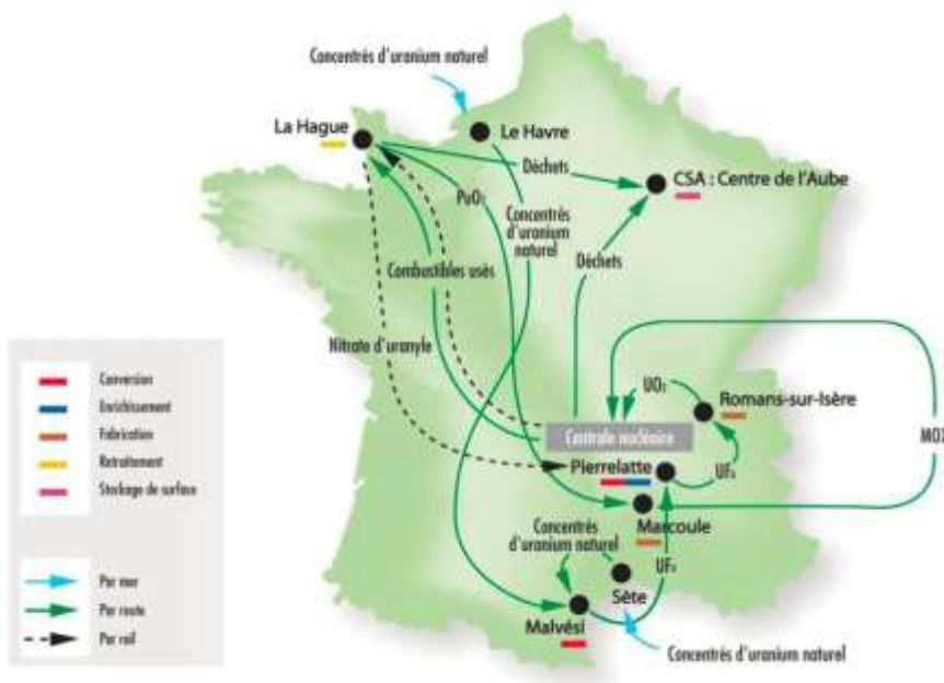
Figure 11 : Les principaux transports liés au cycle du combustible pour une centrale nucléaire donnée (source : ASN 2014 - Étude sur les flux de transport de substances radioactives à usage civil)
