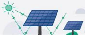
\* Les cellules solaires captent à la fois la lumière du soleil sur la face avant et arrière des panneaux photovoltaïques par réflexion du sol et de son environnement.
