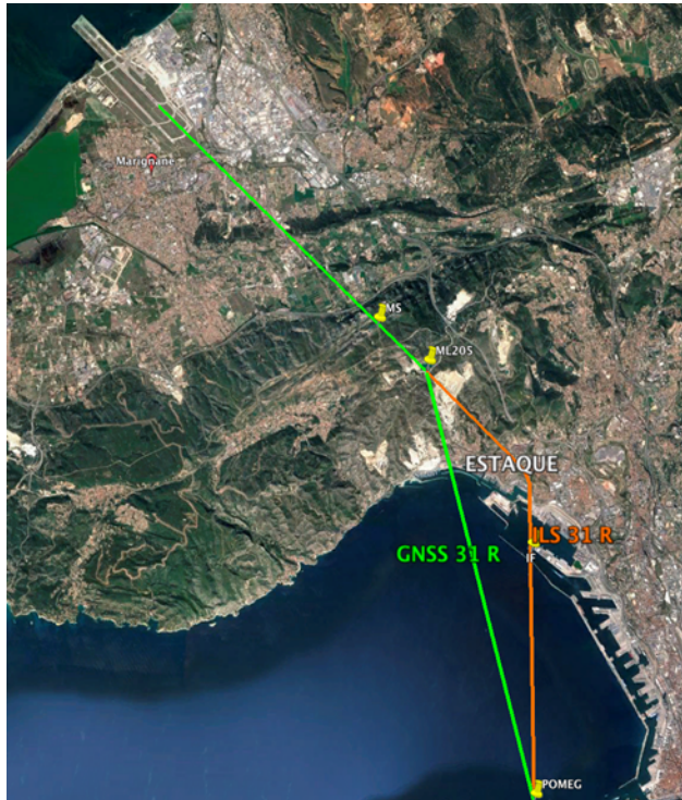
Trajectoires comparées des procédures d'approche face au Nord-Ouest ILS 31 et GNSS 31 R
