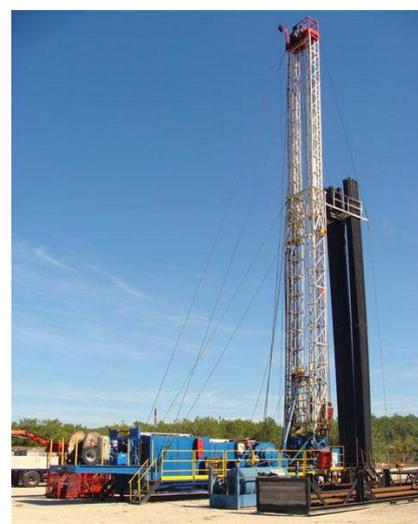
**Figure 12 : Appareil d'intervention à l'occasion d'une réparation de puits**
