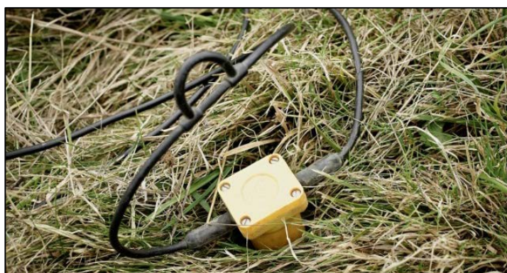
Figure 19 : Déroulage des câbles et pose des géophones © Vermilion
