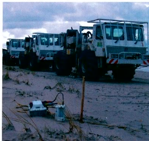
Balisage des récepteurs par piquets
