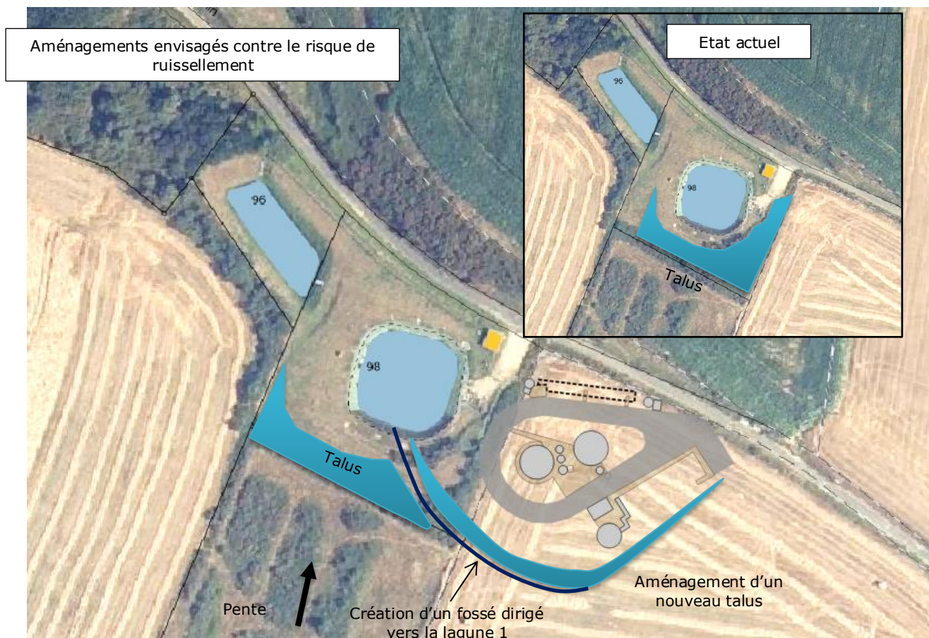
Figure 28 : Aménagements envisagés contre le risque de ruissellement
